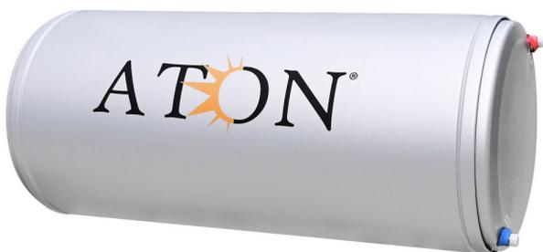
Bollitore per impianti solari a circolazione naturale con caldaia a doppia vetroporcellanatura (DIN4753, parte 3), spessore 3 mm con doppio strato interno di smalto, scambiatore ad intercapedine, anodo di magnesio, isolamento termico ottimizzato e rivestimento esterno duraturo per la massima protezione nelle zone costiere.
