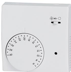
Termostato elettronico per fan coil Wind. Funzioni principali: -accensione/spengimento pompa di circolazione o apertura/apertura chiusura valvola di zona; regolazione temperatura ambiente. Selezione riscaldamento/raffrescamento manuale. Installazione a parete (montaggio esterno). Alimentazione 230 Vca 50 Hz.
